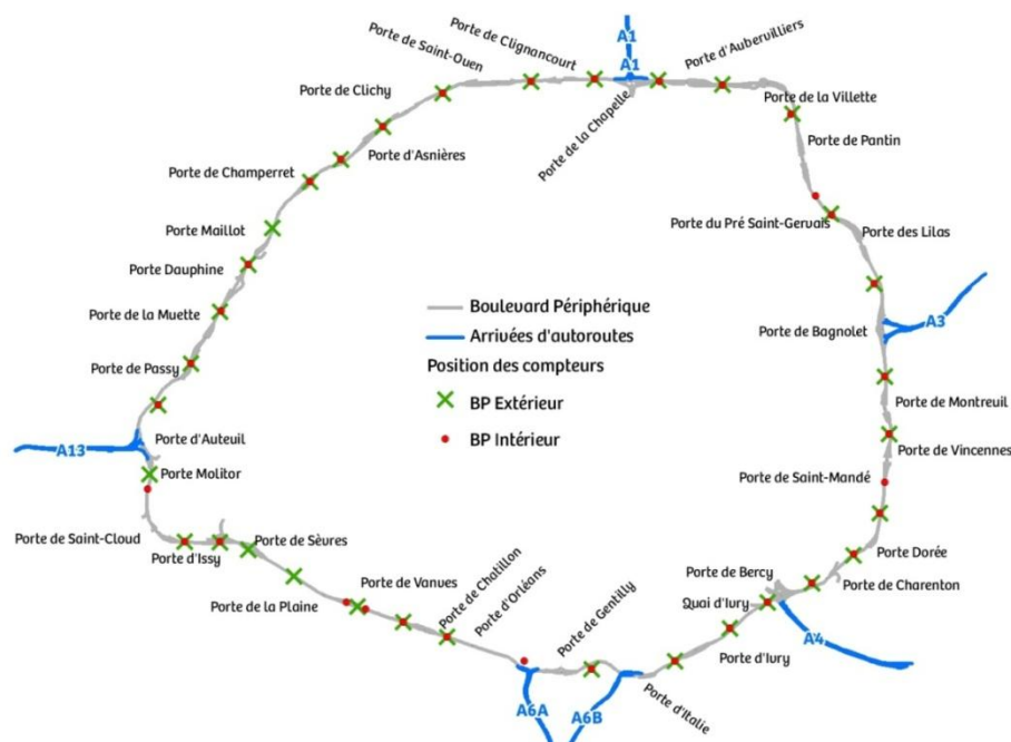
Figure 4 : positions géographiques de boucles de comptage de trafic.
